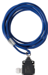
Sterownik linkowy Możliwy montaż poziomy lub pionowy, obudowa z aluminium odlewanego ciśnieniowo, IP 65, długość linki 4 m
