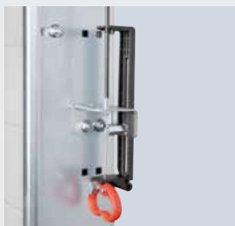
Opcjonalne odryglowanie awaryjne W razie awarii zasilania bramę można łatwo otworzyć ręcznie za pomocą odryglowania awaryjnego. Jest ono oferowane w dwóch wariantach wykonania: przeznaczone do montażu wewnątrz (na ilustracji) i na zewnątrz (w obudowie z odlewem ciśnieniowego zamykanej na klucz)
